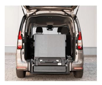
Sistema GENIUS RAMP: quando la persona in carrozzina non è nel veicolo, la rampa di accesso può essere ribaltata internamente. GENIUS RAMP permette di ricreare il piano di appoggio utile per stivare bagagli o altre attrezzature, per un uso versatile di Ford Tourneo Connect.
