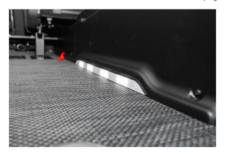
Rivestimenti laterali del pianale in plastica ABS con luci di cortesia a LED integrate. Questa soluzione eleva lo stile e il design dell'ambiente di viaggio; le cui sono temporizzate e si attivano all'apertura del portellone posteriore.
