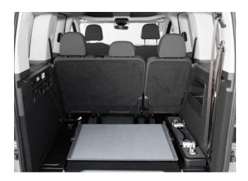
La panchetta può essere sdoppiata 1/3 - 2/3: i sedili originali si ribaltano in avanti con facilità, per ottenere la configurazione 3 posti + 1 carrozzina oppure 2 posti + 1 carrozzina
