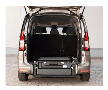
Dispositivi di ancoraggio omologati per una carrozzina, conformi alle normative vigenti, testati in fase di omologazione e composti da:
