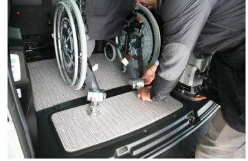
L'aggancio delle cinghie alla carrozzina avviene tramite un uncino e la tensione alla cinghia verrà effettuata automaticamente con serraggio finale tramite manopola.
