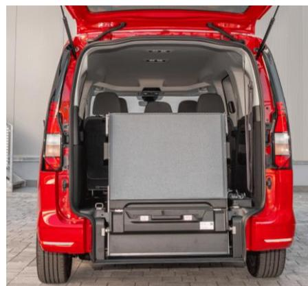
► **Sistema GENIUS RAMP:** quando la persona in carrozzina non è nel veicolo, la rampa di accesso può essere ribaltata internamente. GENIUS RAMP permette di ricreare il piano di appoggio utile per stivare bagagli o altre attrezzature, per un uso versatile di Connect Maxi wav.
