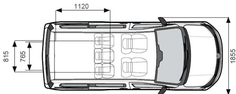
Altezza punto di ingresso **1395 mm** | Altezza interna utile **1430 mm** | Lunghezza area stazionamento carrozzina **1120 mm** | Larghezza area stazionamento carrozzina **815 mm** | Lunghezza rampa aperta **1390 mm** | Larghezza utile rampa di accesso **765 mm**
